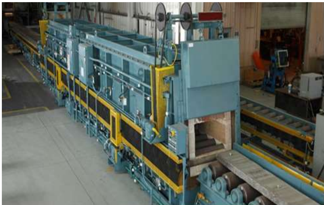
Рис. 1.4. Загальний вигляд прохідної печі
