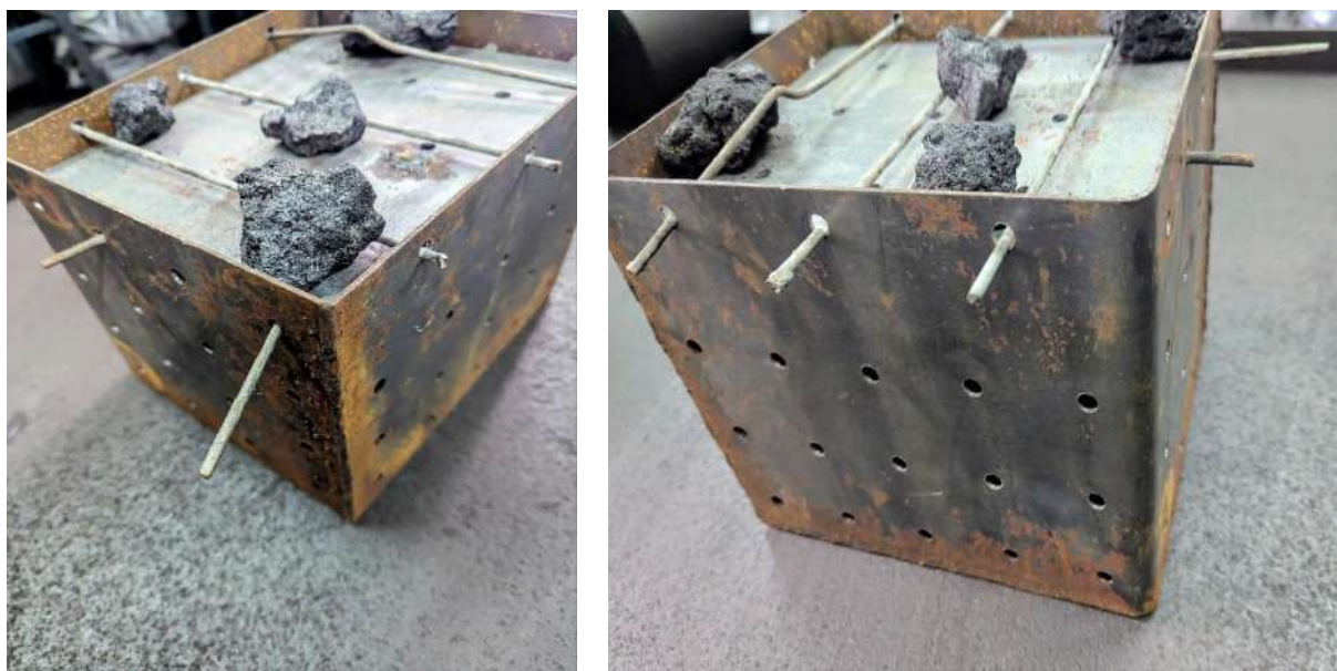
Рис.2.1. Ящики металеві для коксування дослідних шихт
