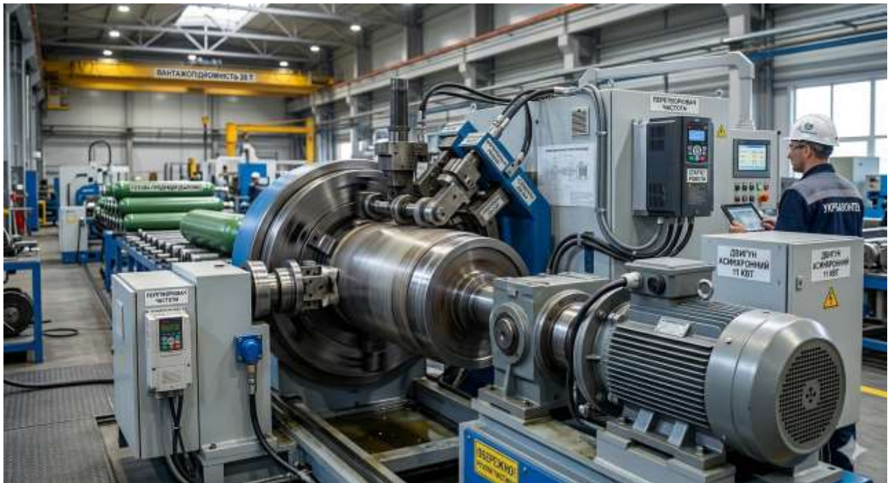
Рис. 1.7. Ротаційна машина формування металевих балонів високого тиску
