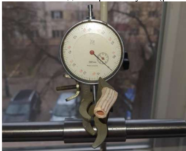
Рис. 4.9. Встановлення індикатора на «нуль» для контролю радіального биття вала
