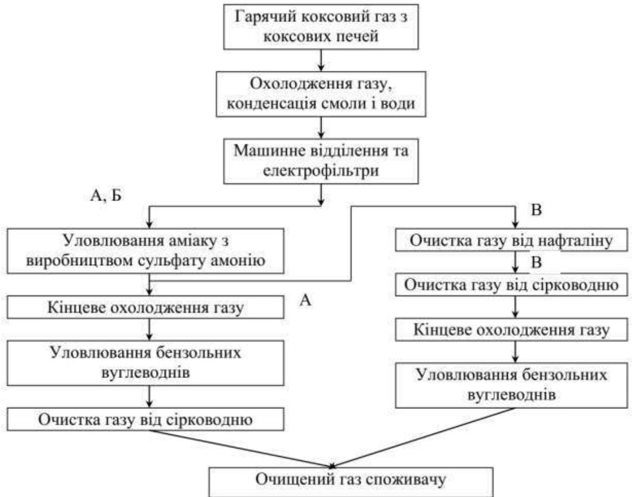
Рис.1.1. Послідовність технологічних операцій обробки коксового газу
