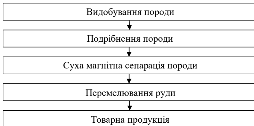
Рис. 2.1. Схема технологічного процесу виробництва продукції АТ «Кривбасзалізрудком»
