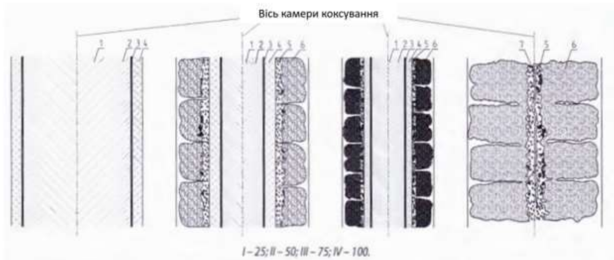
Рис. 1.3 Схема розподілу шарів у завантаженні по ширині камери коксування
