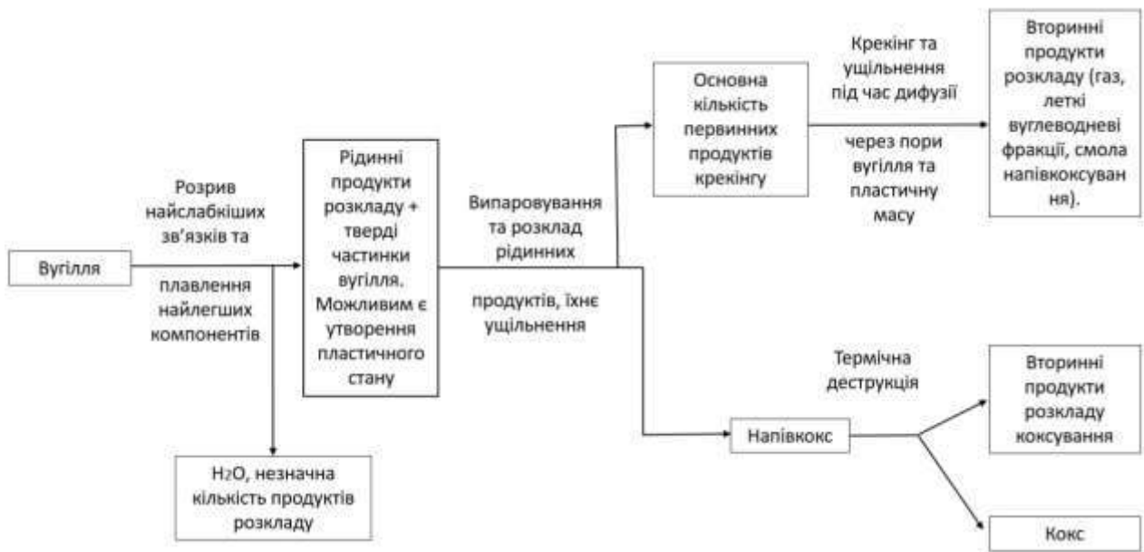
Рис. 1.1 Загальна схема процесу термодеструкції вугілля
