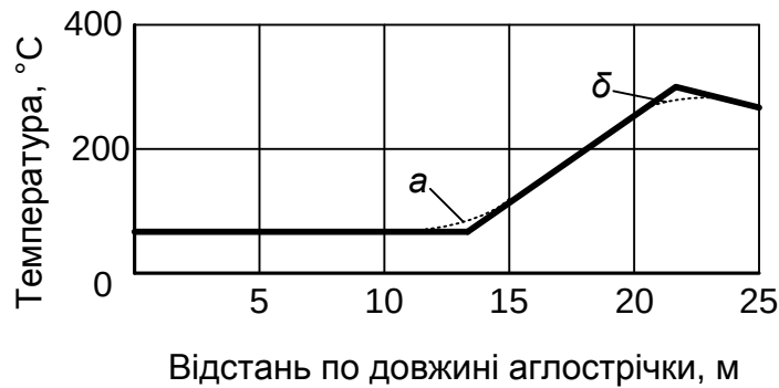
Рис. 2.8. Характер зміни лінії спікання і температурного графіка при різному ступені допикання:
