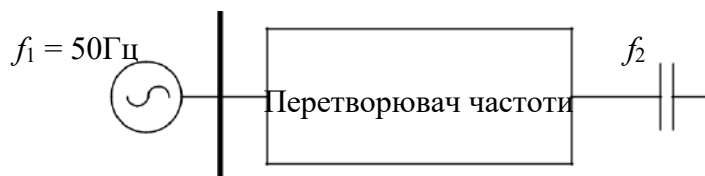
Рис. 2.5 – Схема регулювання зміною частоти
