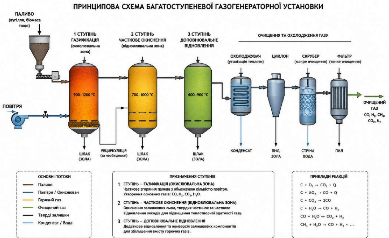
Рисунок 2. 2 – Принципова схема багаступеневої газогенераторної установки
