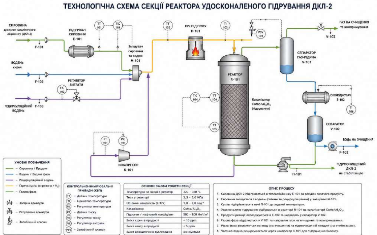
Рисунок 2.7 – Технологічна схема секції реактора удосконаленого гідрування ДКЛ-2
