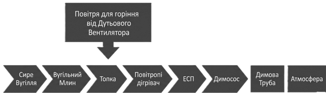
Рис.2.3. Схема технологічного процесу вугільної електростанції
