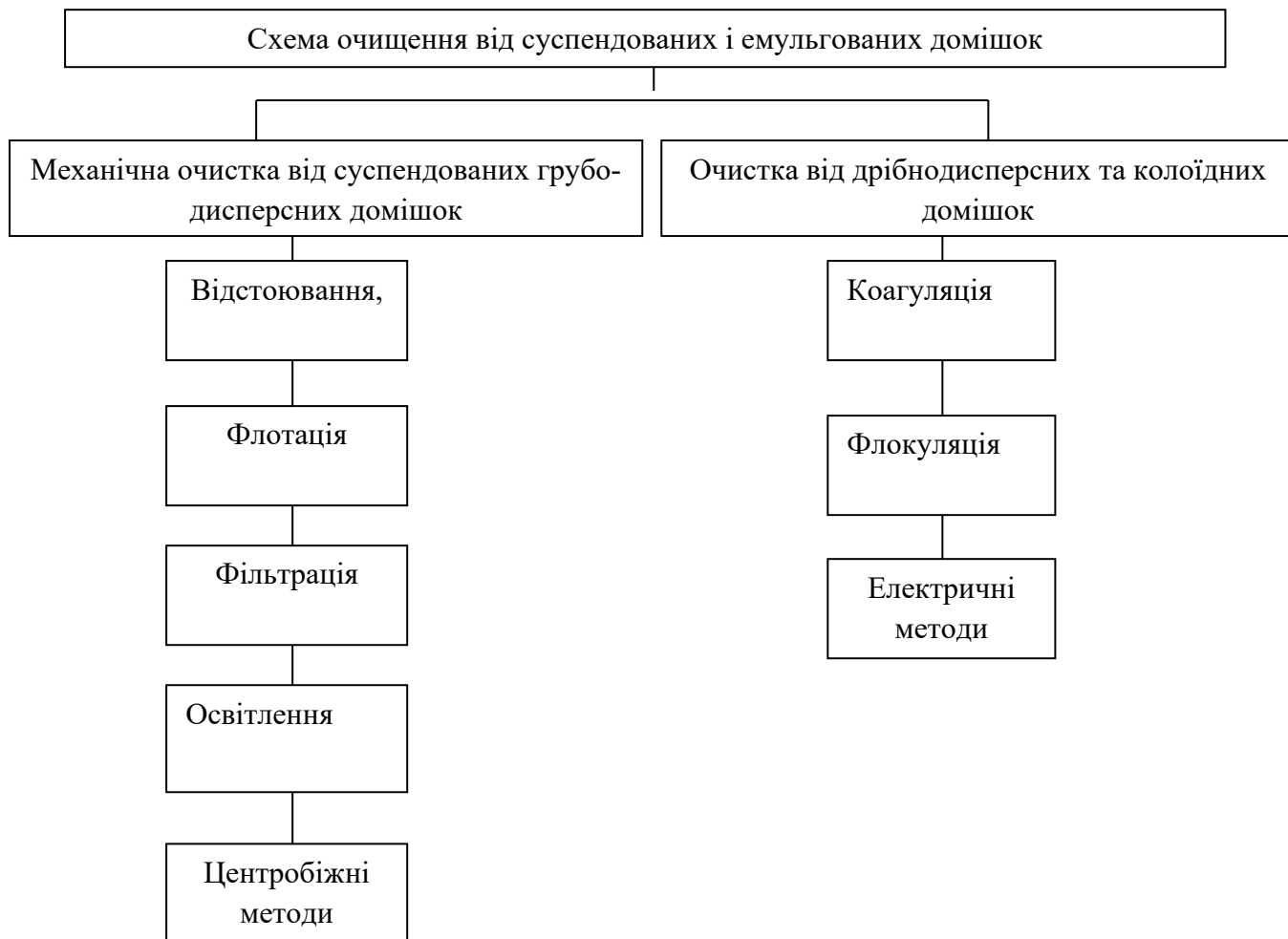
Рис.1.3. Схема очищення від суспензійних і емульгованих домішок
