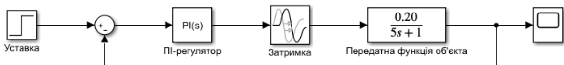
Рис. 2.23 Модель перехідної характеристики контуру витрати повітря (співвідношення «паливо-повітря»)
