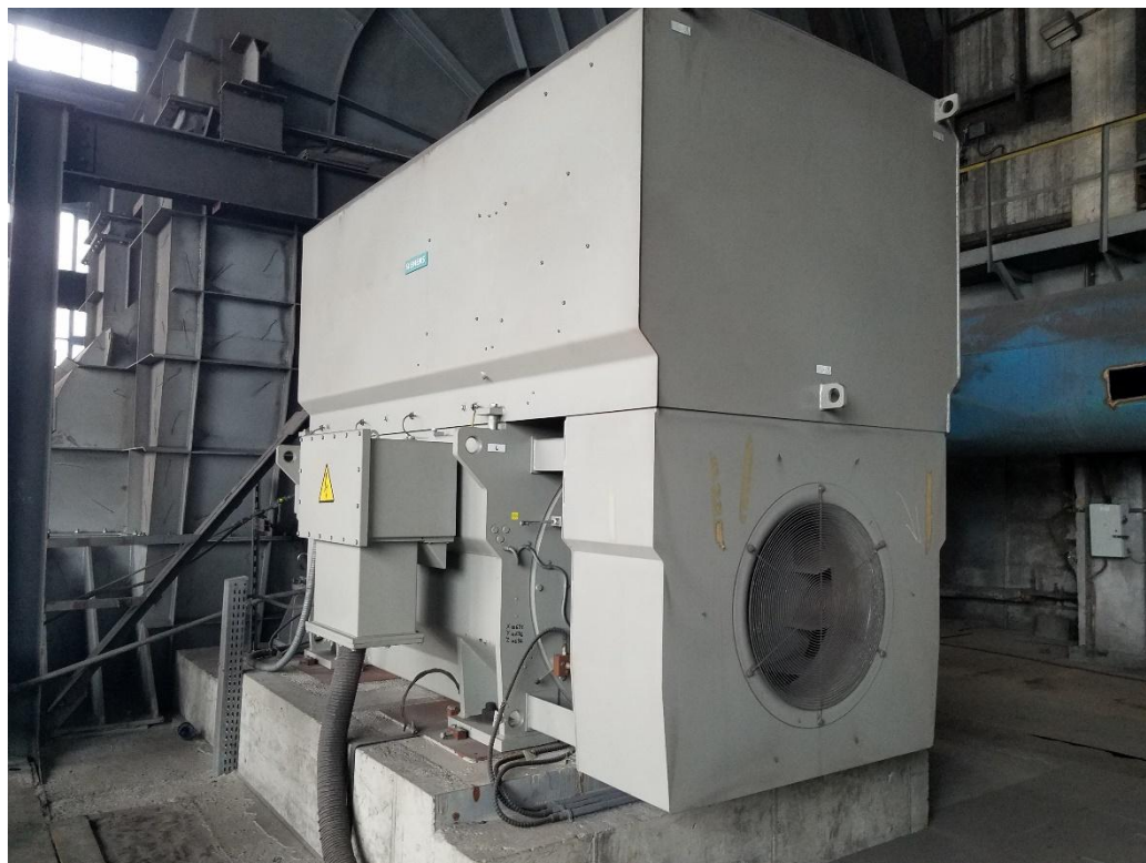
Рис.1.3. Електродвигун Siemens 1RQ4 636-6JE80-Z
