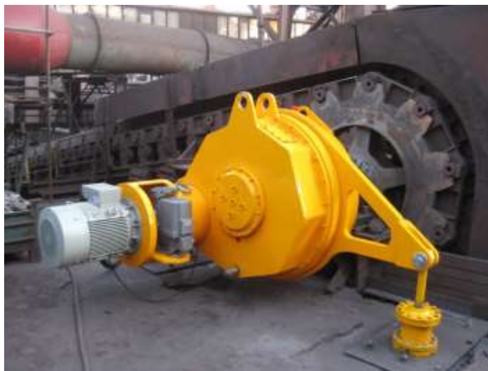
Рис.1.8. Привід агломераційної машини
