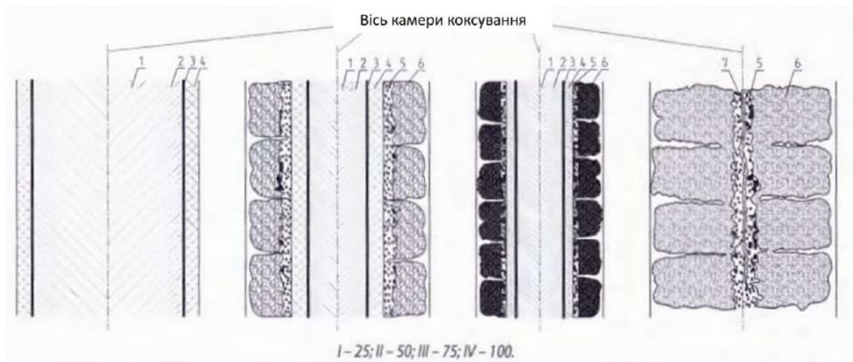
Рис. 1.1 Схема розподілу шарів у завантаженні по ширині камери коксування
