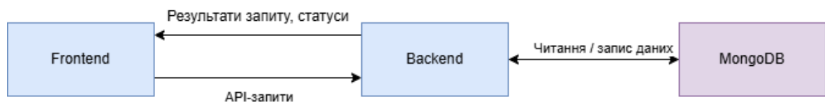
Рис. 3.4. Схема взаємодії між клієнтською частиною, сервером і базою даних
