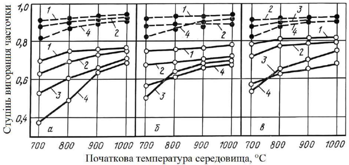
Рис. 2.6. Вплив виду палива і початкової температури середовища на ступінь вигорання паливних частинок крупністю 1-2 (а), 2-3 (б) і 35 мм (в); ● – \tau = 0,5\tau_{згор} ; ○ – \tau = 0,75\tau_{згор} ; цифри у кривих 1-4 – те саме, що й на рис. 2.5
