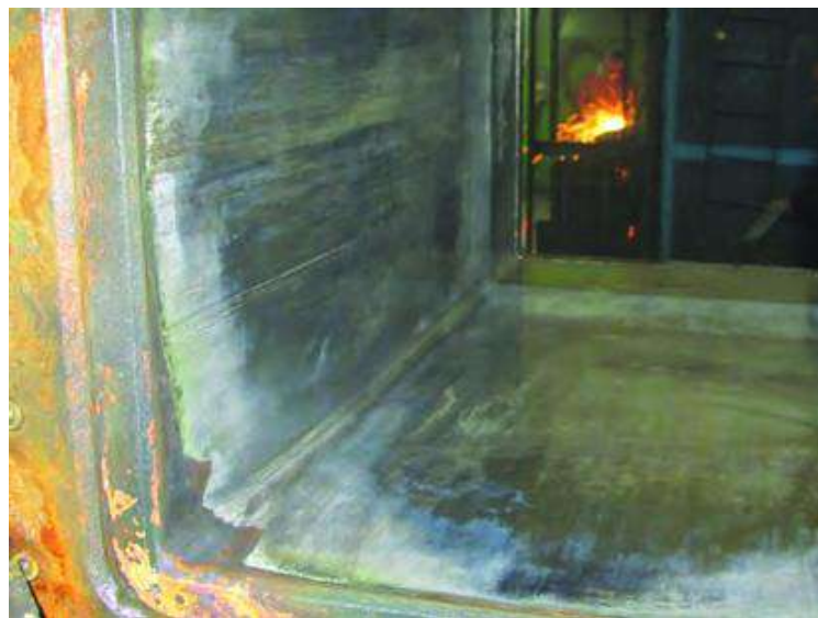
Рис.1.11. Гільза після проходження 88 плавок
