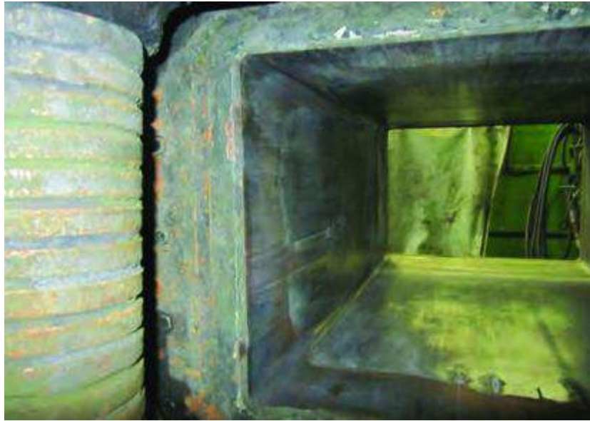
Рис. 1.5. Гільза після проходження 89 плавок
