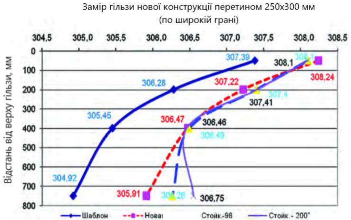
Рис. 1.3. Зміна геометрії гільзи по широкій грані в процесі використання
