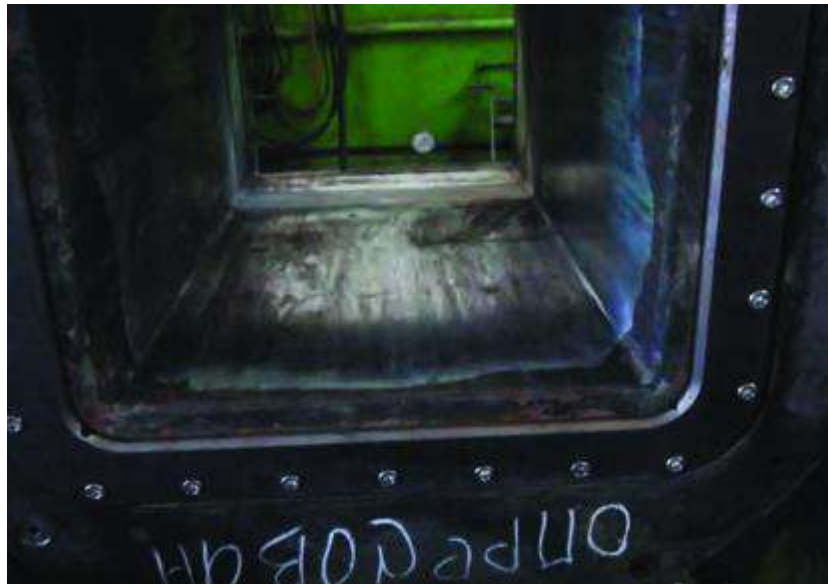
Рис. 1.6. Дослідна гільза після проходження 96 плавок
