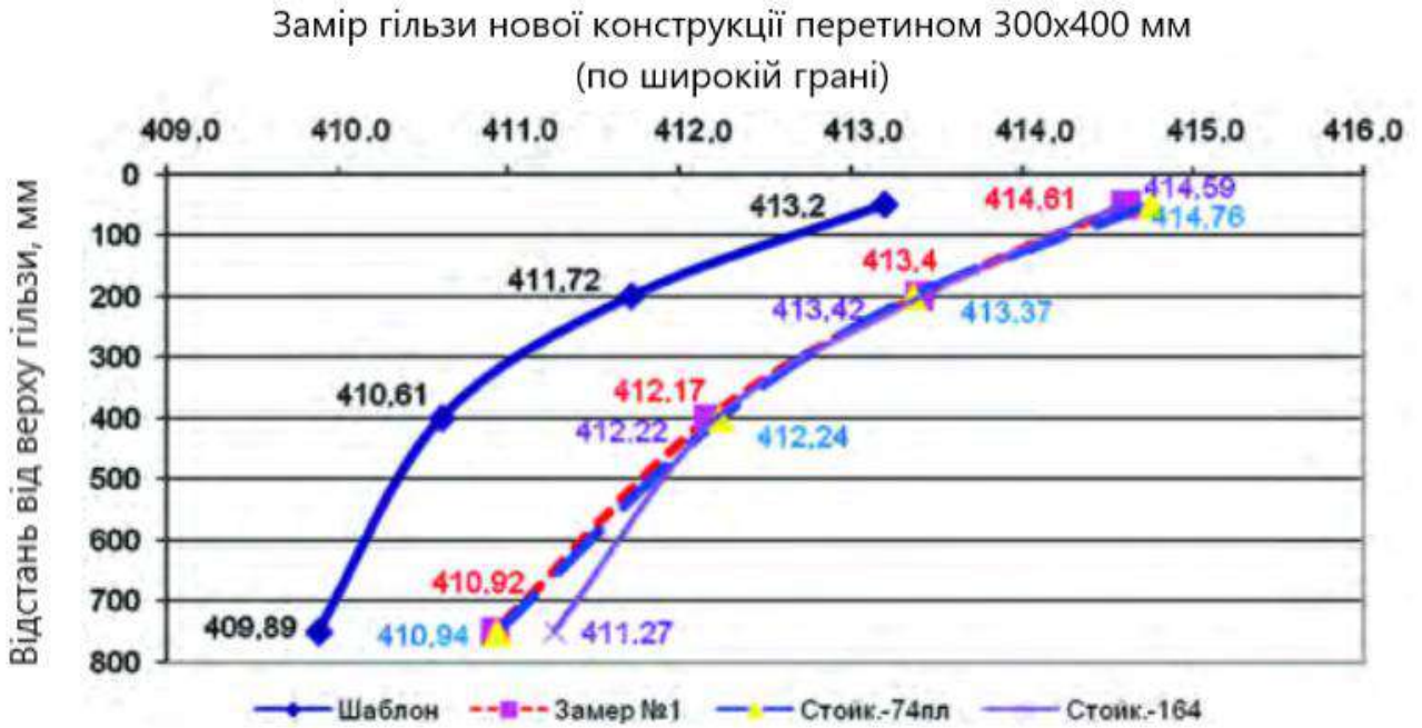
Рис.1.9. Зміна геометрії гільзи по широкій грані в процесі використання
