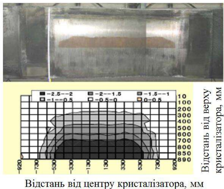
Рис. 2.18 Дані по зносу слябових кристалізаторів з Ni гальванопокриттям після 700 плавок, мм
