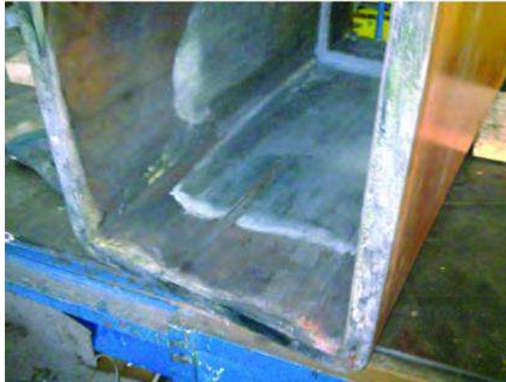
Рис.1.11. Гільза після проходження 88 плавок
