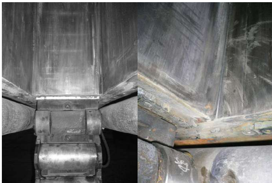
Рис.2.25 Фотографія стінок кристалізатора з газотермічним Ni-Cr покриттям після напрацювання в 1943 плавки (310 тис. тон металу)
