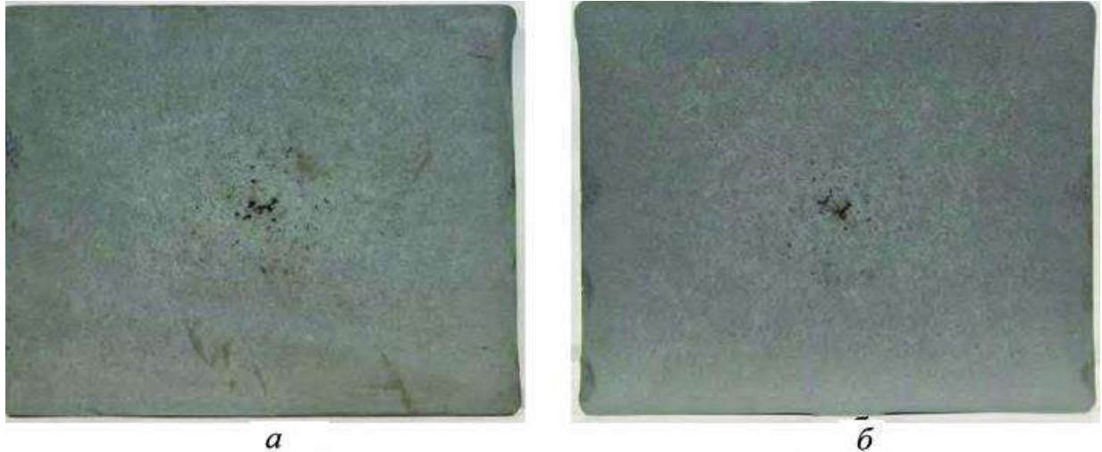
Рис.1.13. Темплети поперечного перерізу безперервнолитого блюму перетином 250x300 мм плавки 336006: а - 2-й струмок (порівняльний); б - 4-й струмок (дослідний)
