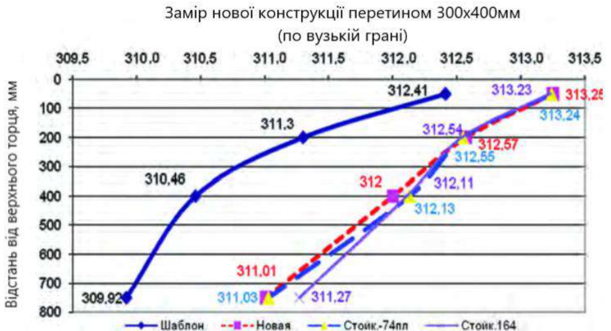
Рис.1.10. Зміна геометрії гільзи по вузькій грані в процесі використання
