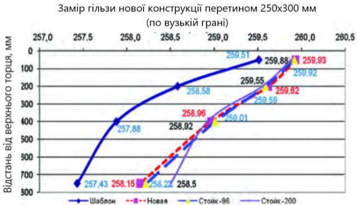
Рис. 1.4. Зміна геометрії гільзи по вузькій грані в процесі використання
