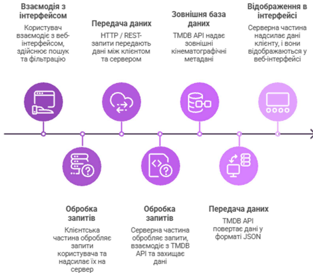
Рис. 1.12 Узагальнена схема архітектури веб-застосунку з використанням TMDB як зовнішньої бази даних
