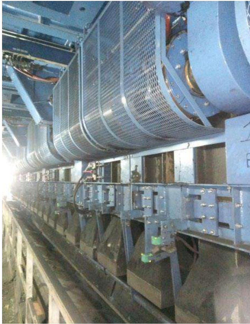
Рис. 2.7. Трамбувальна машина. Вид зсередини. Примітка. Джерело: розроблено з використанням [34]
