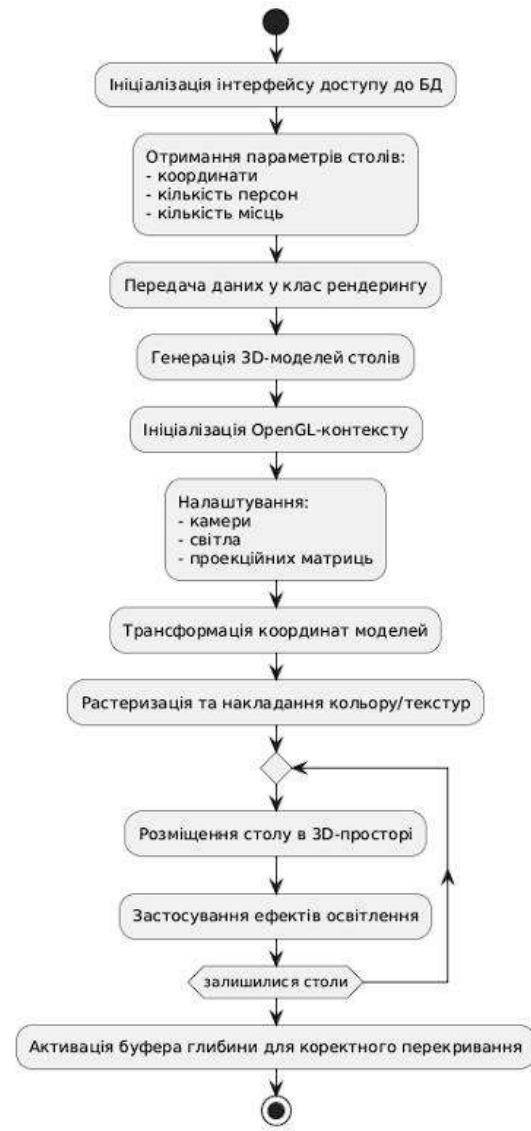
Рис. 2.5. UML-діаграма «Робота візуального модуля»
