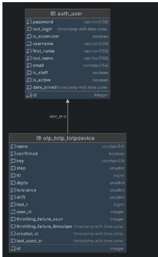
Рис. 2.8. Структура бази даних для автентифікація через генератор токенів
