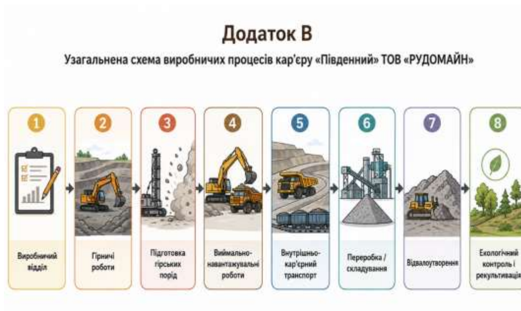
Рисунок В.1 — Узагальнена схема виробничих процесів кар'єру «Південний» ТОВ «РУДОМАЙН»
