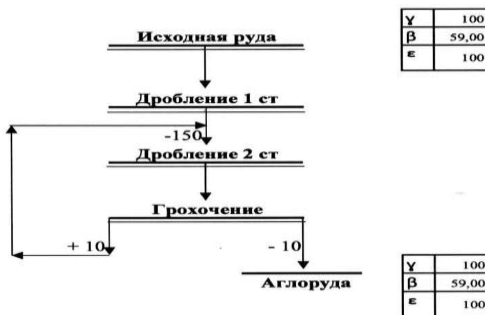
Рис. Е.2 Технологічна схема дробарного комплексу (ДК)
