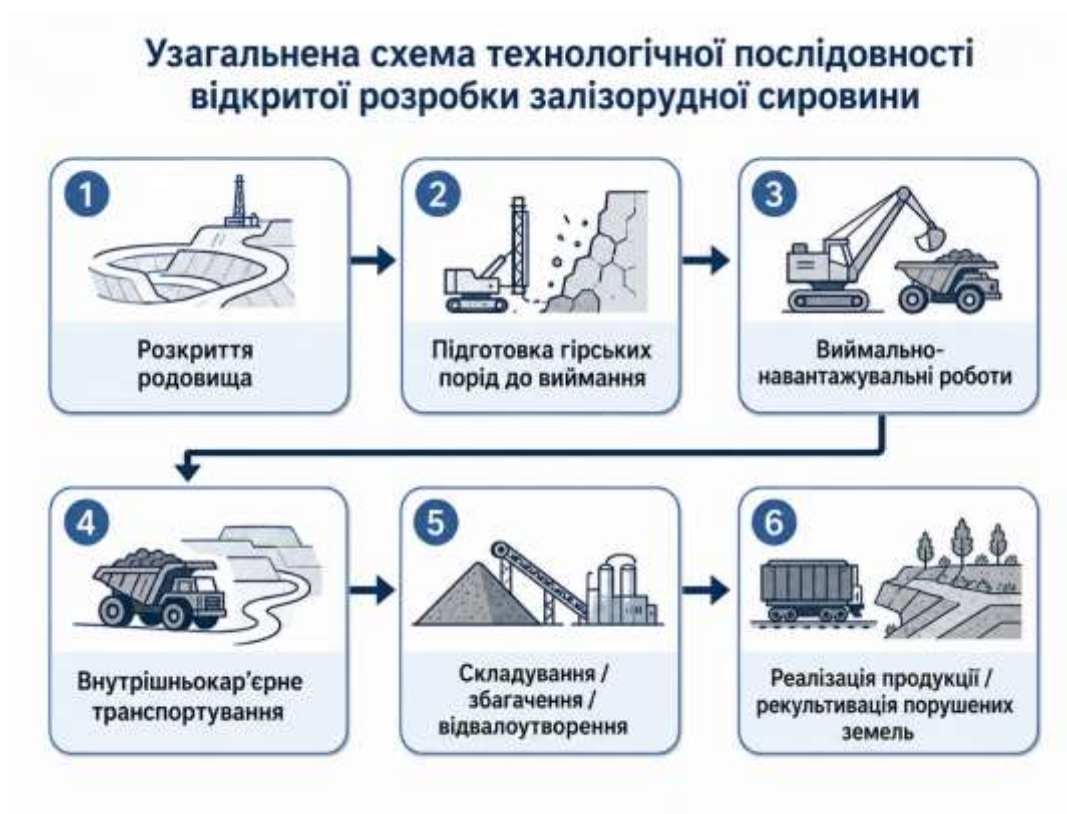
Рисунок Б.1 — Узагальнена схема технологічної послідовності відкритої розробки залізорудної сировини
