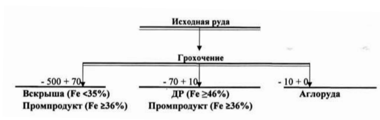
Рис. Е.3 Технологічна схема сортувального комплексу (СК)
