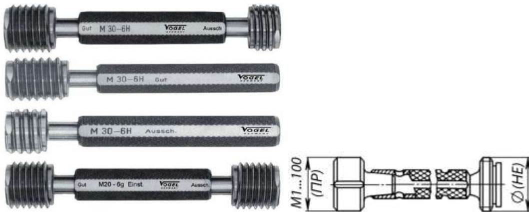
Рис. 7.6. Комплексний контроль внутрішньої різьби різьбовими пробками
