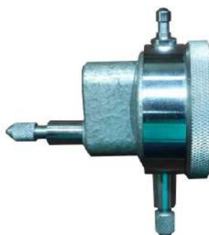
Рис. 6.4. Індикатор годинникового типу з двома вимірювальними стрижнями
