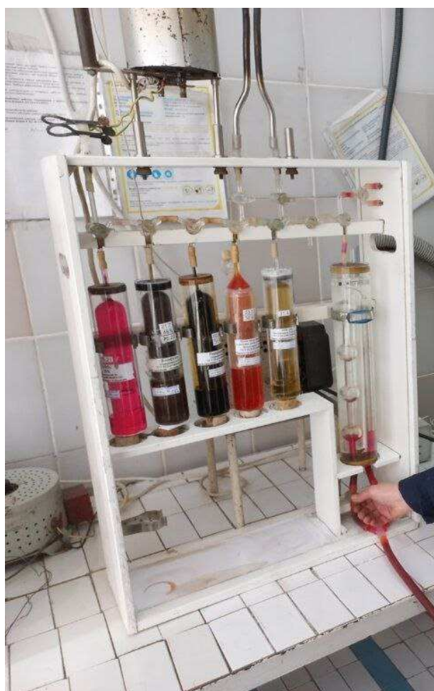
Рис. 2.2 – Загальний вигляд апарату ВТІ підготовленого до роботи
