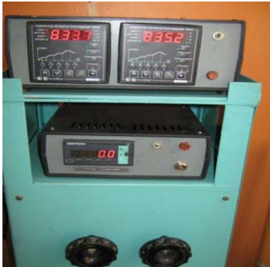
Рис. 1.6. Поетапне виконання робіт на установці по визначенню тиску розпирання
