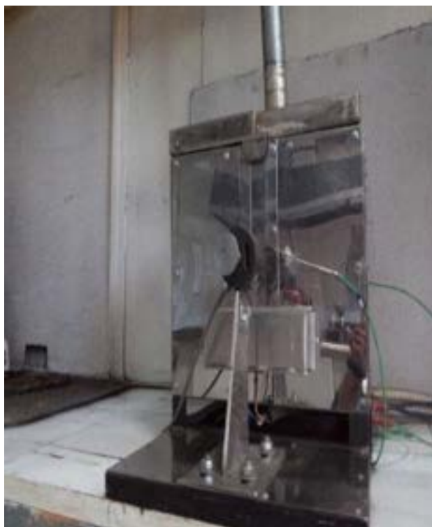
Рис. 1.6. Поетапне виконання робіт на установці по визначенню тиску розпирання
