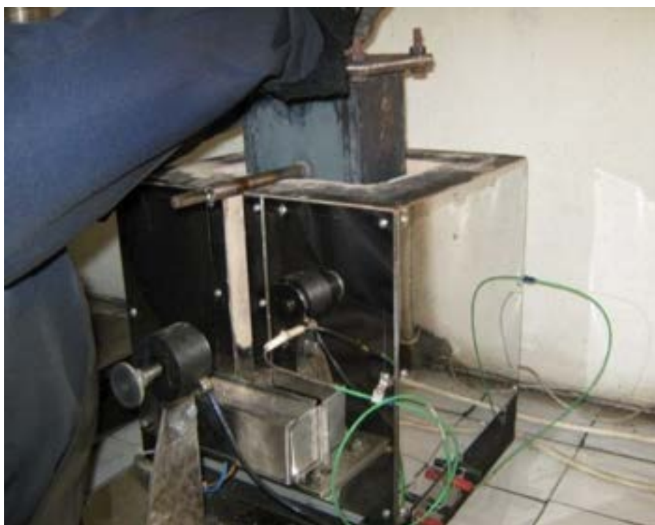
2. Установка реторти в камеру
