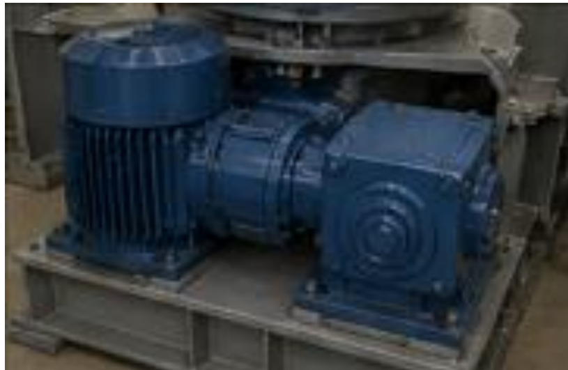
Рис.2.5 Привідний механізм (двигун та редуктор).
