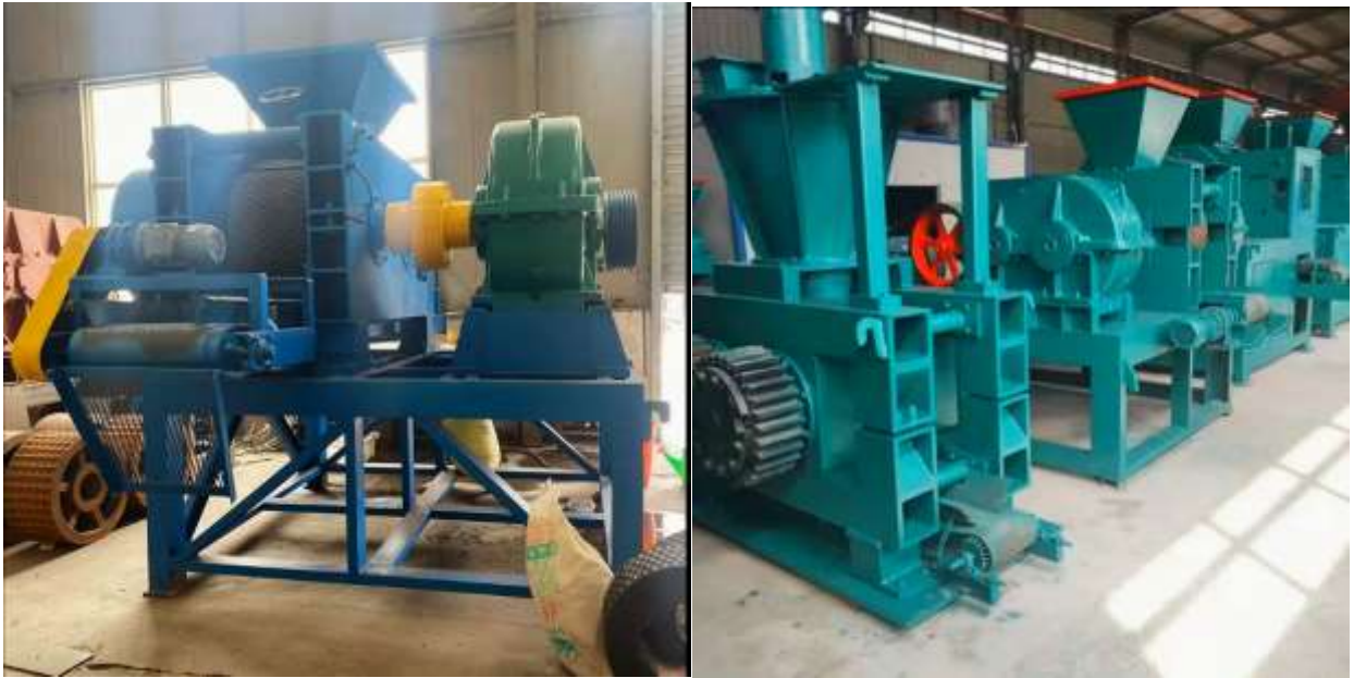
Рис.2.6. Вальцевий прес для пресування та формування вугільних брикетів
