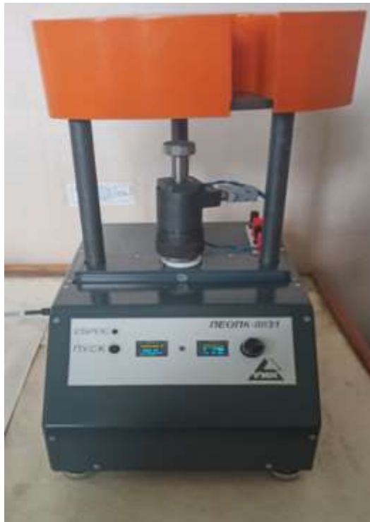
Рис.2.2. Установка для визначення питомого електричного опору
