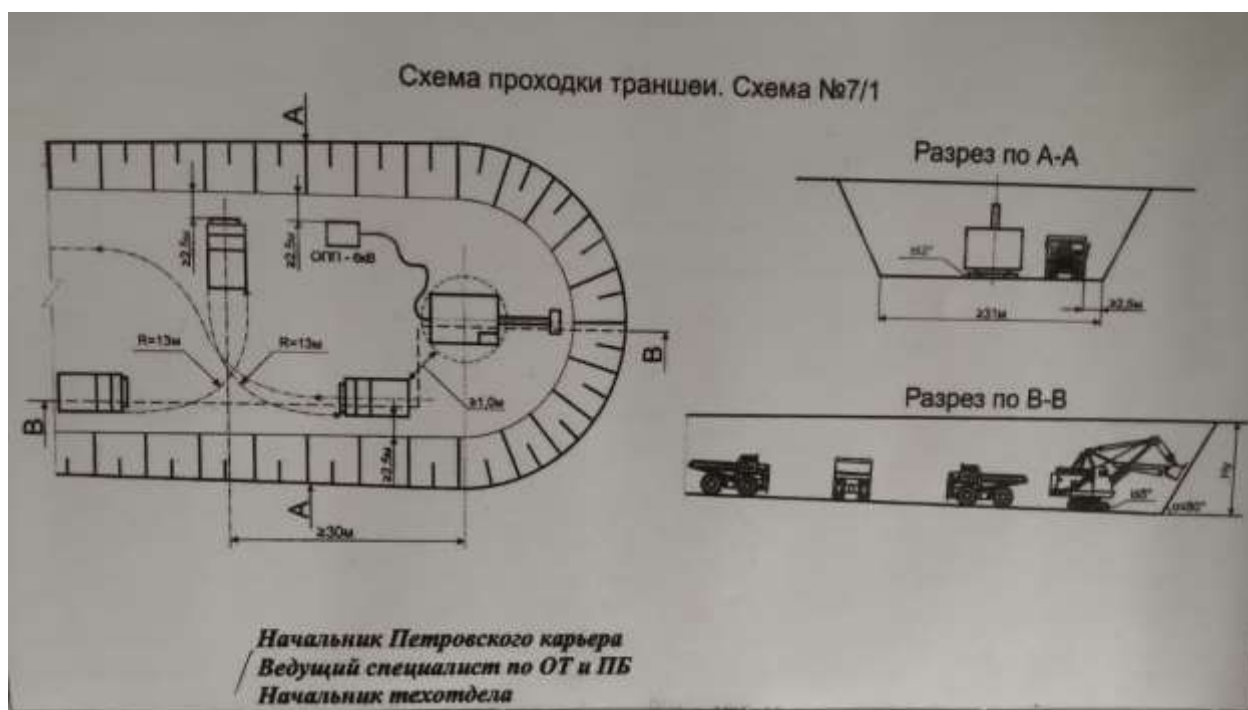
Рисунок В.1 — Схема проходки траншеи экскаватором у скельному вибої
