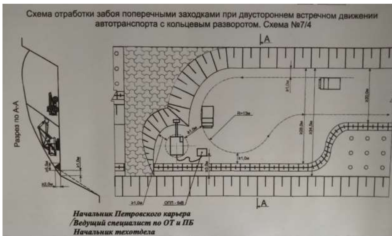
Рисунок В.4 — Схема відпрацювання вибою поперечними заходками з кільцевим розворотом автотранспорту, варіант 2
