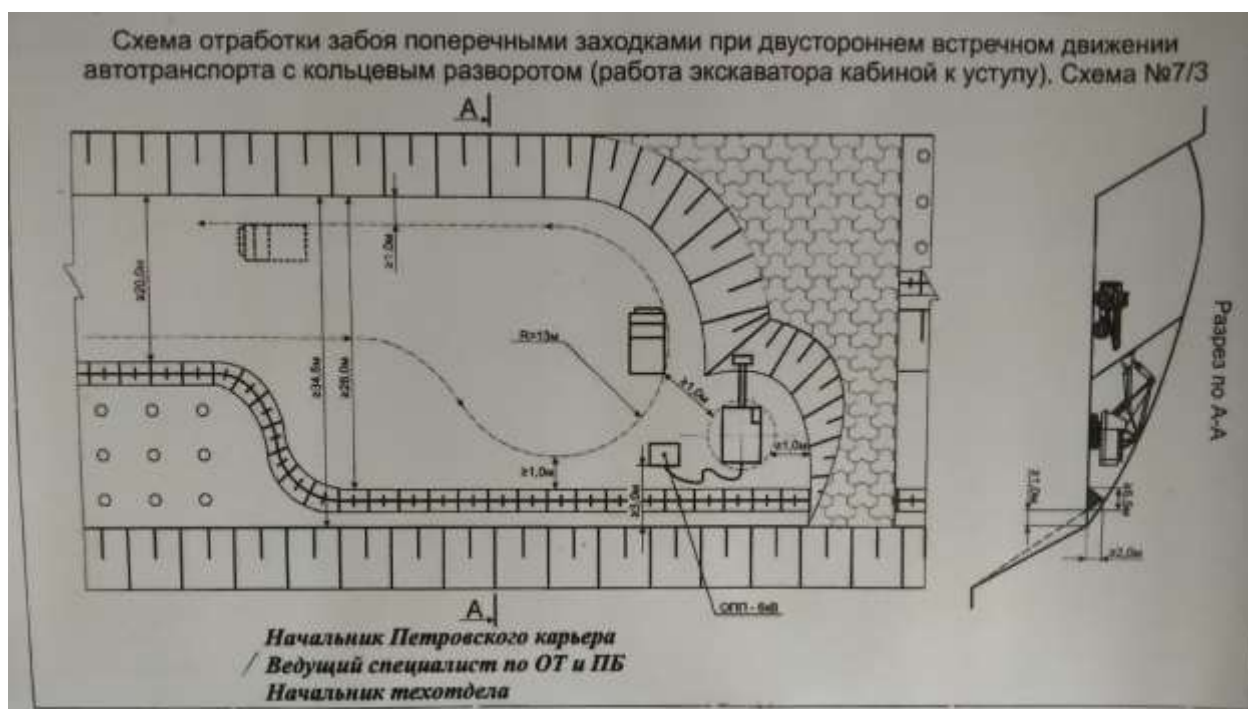
Рисунок В.3 — Схема відпрацювання вибою поперечними заходками з кільцевим розворотом автотранспорту
