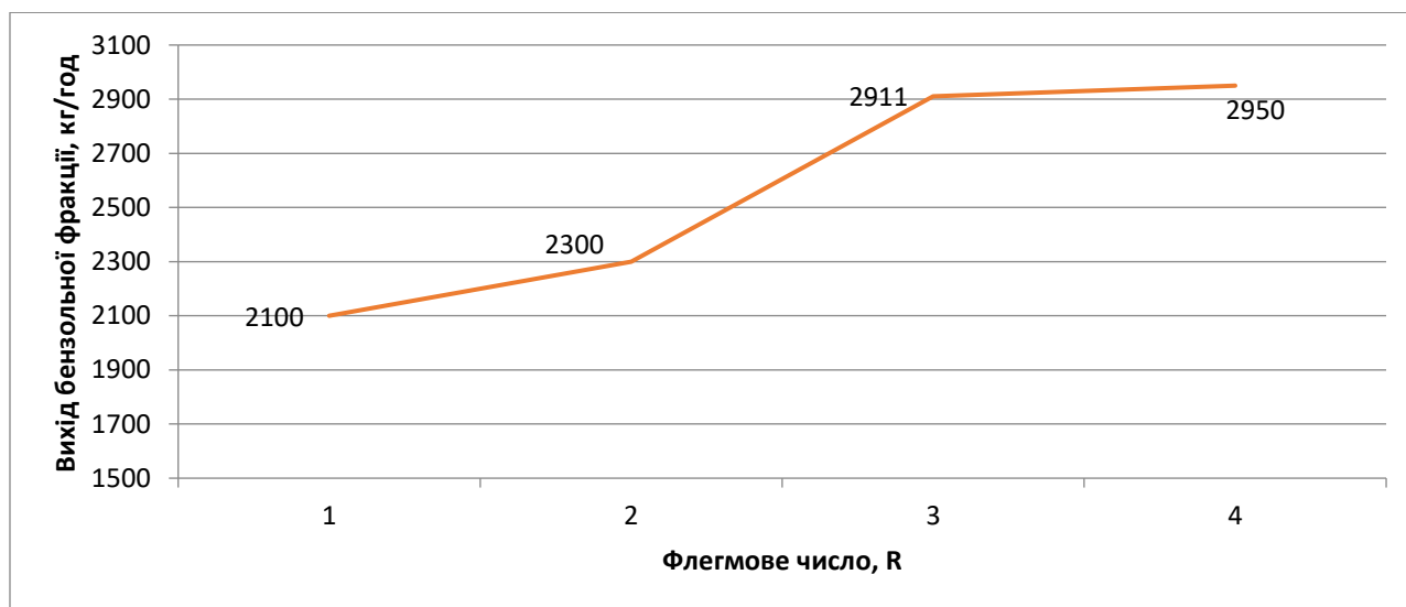
Рис. 2.2 Залежність виходу бензольної фракції від флегмового числа
