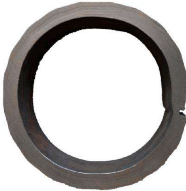
Рис. 1.8. Поперечний переріз оболонки з тріщиною
