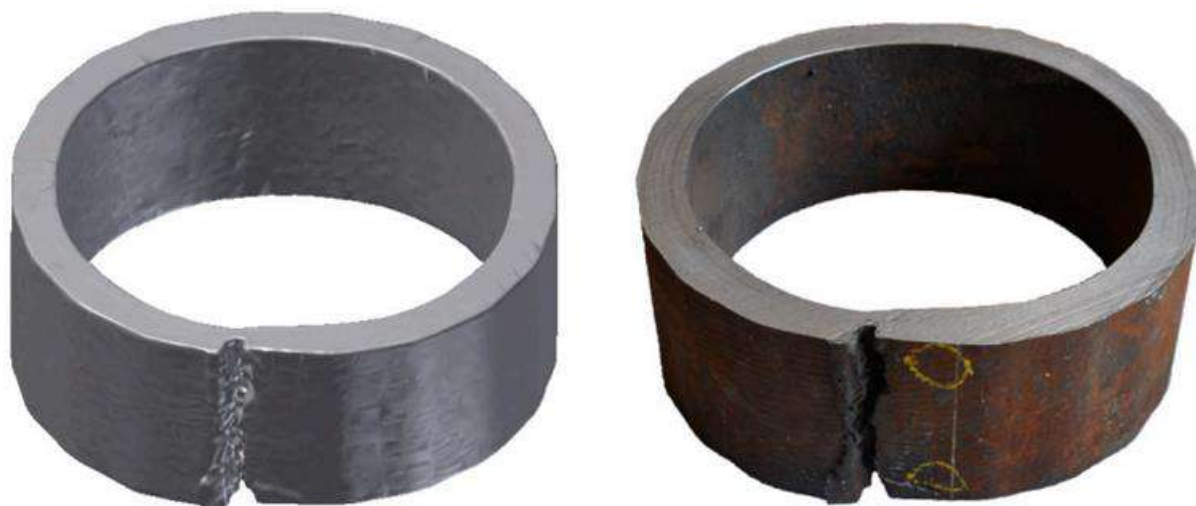
Рис. 1.9. Відсканована (ліворуч) та реальна (праворуч) частина шкаралупи
