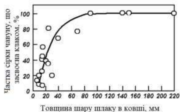
Рис. 2.2 Залежність масової частки видаленої з чавуну сірки, засвоєної шлаком, від товщини шару шлаку в ковші
