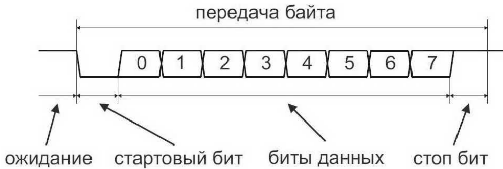
Рис. 4.17 Формат послідовного коду даних UART
