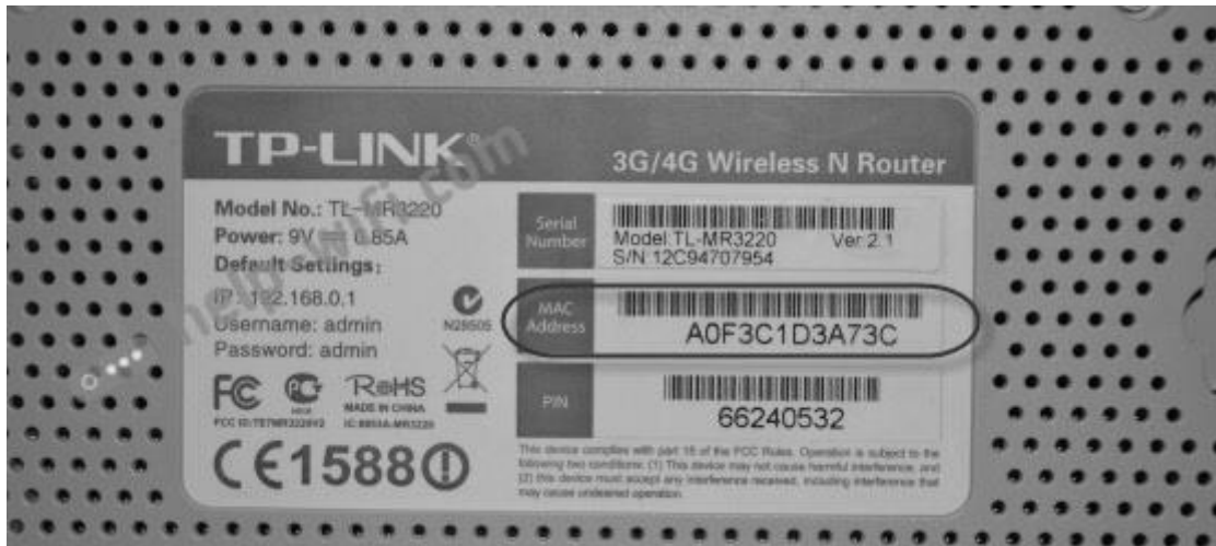
Рис. 3.4 MAC-адреси на маршрутизаторі Tp-Link
