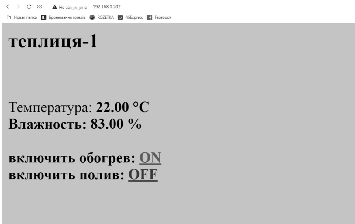
Рис. 7.10 Демонстрація роботи веб-сервера «Клімат-контроль».
