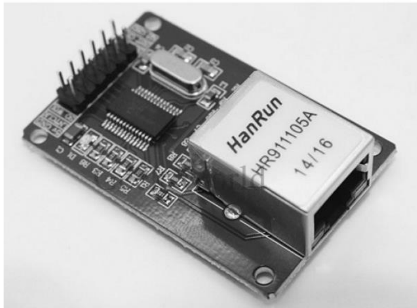
Рис. 7.1 LAN Ethernet шилд HR911105A на мікросхемі ENC28J60
