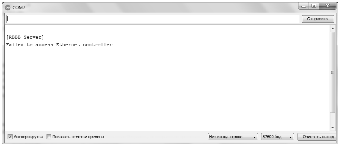
Рис. 7.6 Демонстрація роботи RBBB як веб-сервера з EtherCard через монітор порта (немає доступу до контролера Ethernet).
